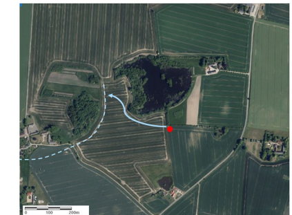
Figur 2. Aftanding af oppumpet vand er markeret med lysblå pile. Den røde prik markerer placering for den planlagte nye indvindingsboring. Omrentlig placering af rørført vandløb er markeret med stiplede blå linje.
