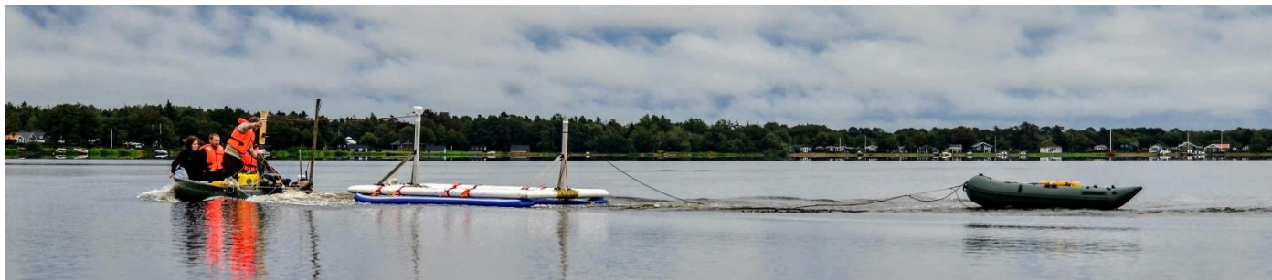
Figur 2. FloaTEM systemet. Senderrammen er monteret på to SUP-boards og modtageren trækkes efter i en lille gummi-båd. Hele systemet slæbes efter en lille motorbåd.
