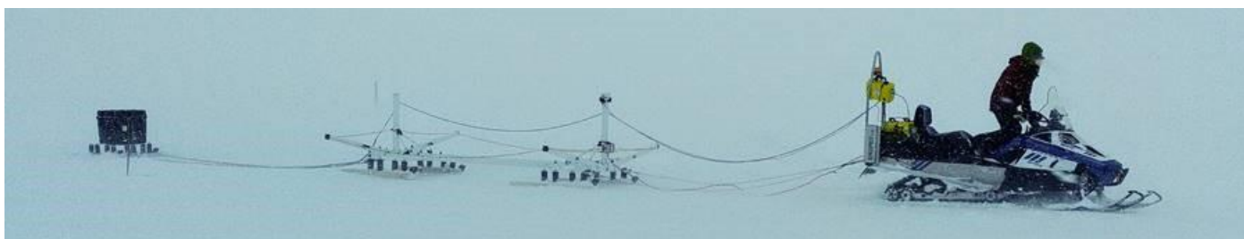
Figur 3. SnowTEM systemet. Mederne på slæderne er gjort bredere så de agerer som ski og hele systemet trækkes af en snescooter.
