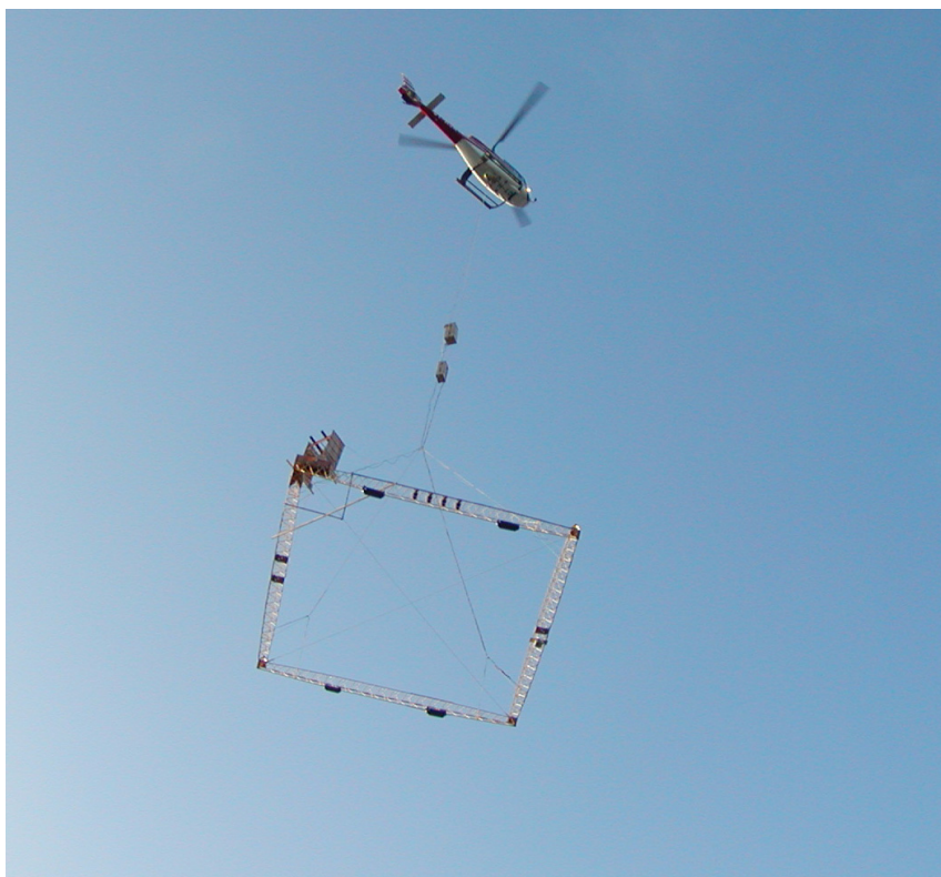
Figur 7.1 SkyTEM i funktion set fra jorden. Den store ramme danner senderspolen. Modtagerspolen er placeret i det bagerste hjørne.
