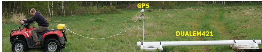
Figur 5. DualEM-421s geometri og feltbillede. Den horisontale sender (T) er placeret i fronten (0 m). Afstandene til modtagerspolerne (HCP, PRP) er ca. 4, 2 og 1 m, deraf navnet DualEM-421s.
