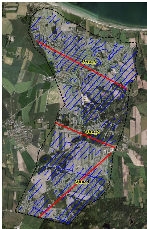
Figur 18. Profilplaceringer. De røde linjer markerer de tre voxel-profiler. Blå, SkyTEM-data, grå GCM-data.
